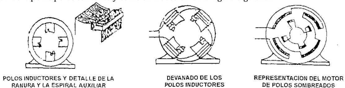
Alrededor de los polos van arrolladas las bobinas inductoras. Los polos llevan cerca de una extremo una ranura longitudinal en el cual se aloja un anillo o espira de cobre en corto circuito, conocida como bobina de sombra.
